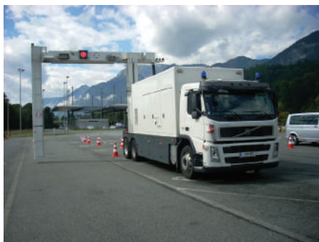
Mit dem Scan-Mobil können ganze Lkw-Züge und Container kontrolliert werden. Foto © BMF/Hans Ringhofer
